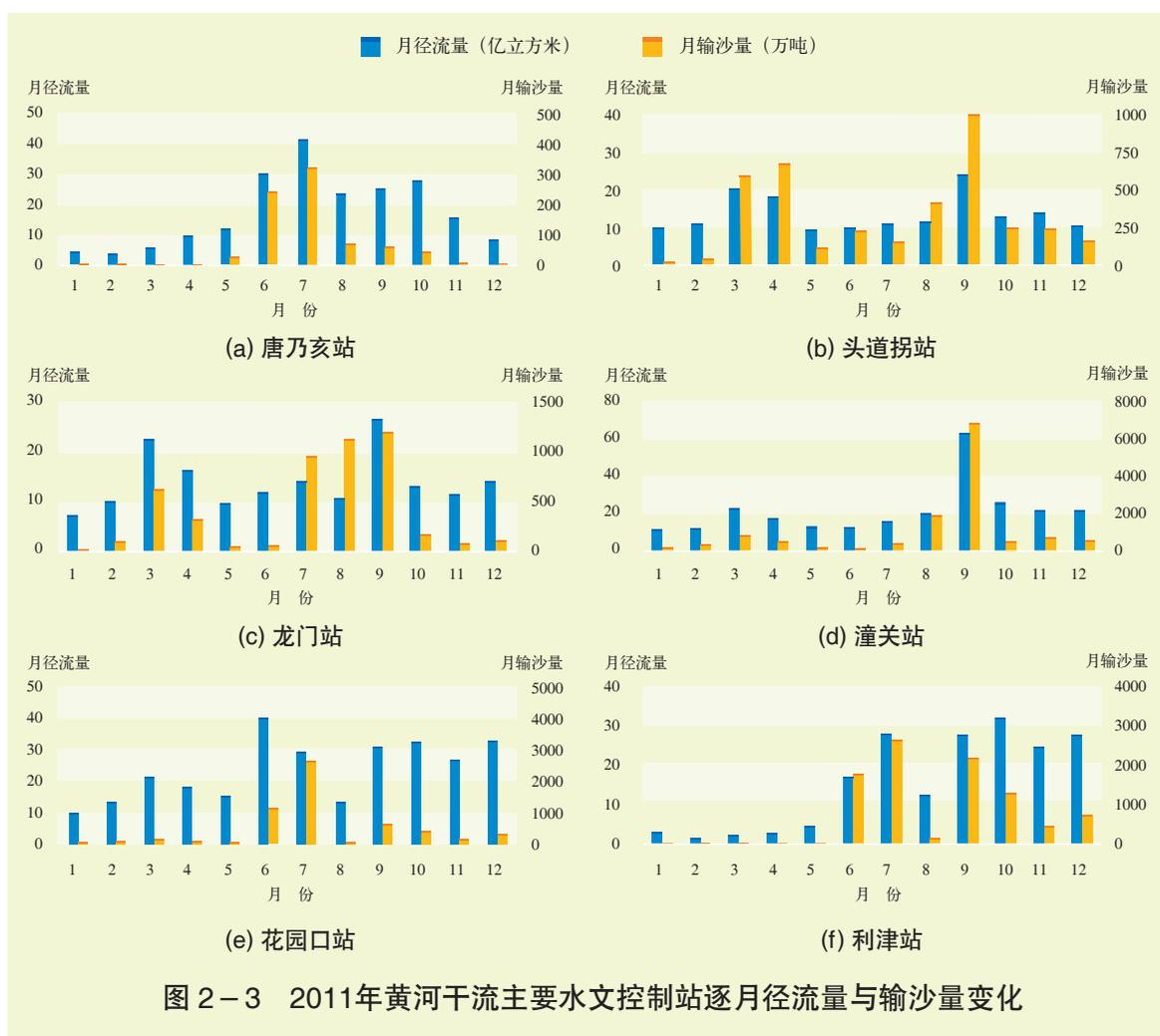
图 2-3 2011年黄河干流主要水文控制站逐月经流量与输沙量变化
